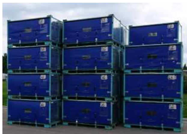
Abbildung 1. Sonderladungsträger im Automobilbau für den Transport von Türinnenverkleidungen
