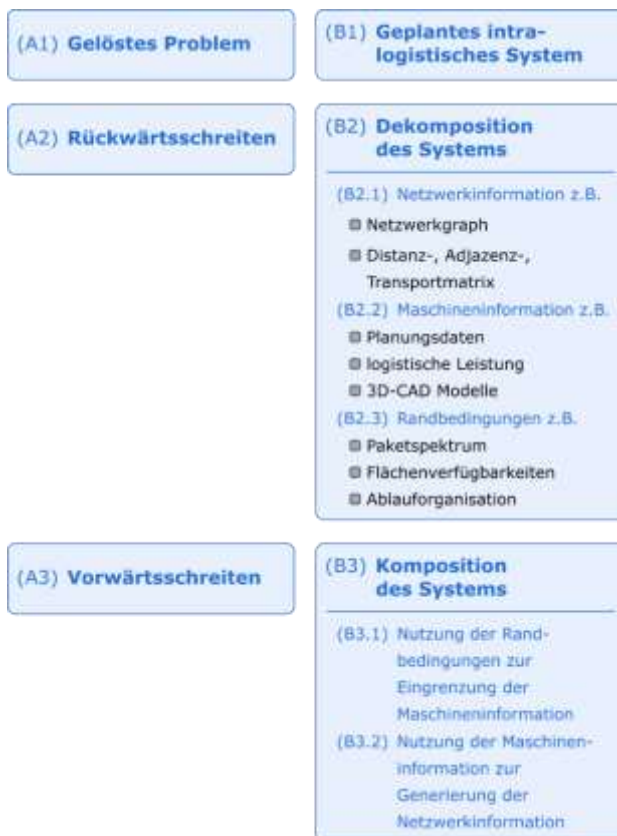
Abbildung 2. Grobvorgehen bei der Anwendung der Heuristik nach Pappos von Alexandria zur Entwicklung der Methode
