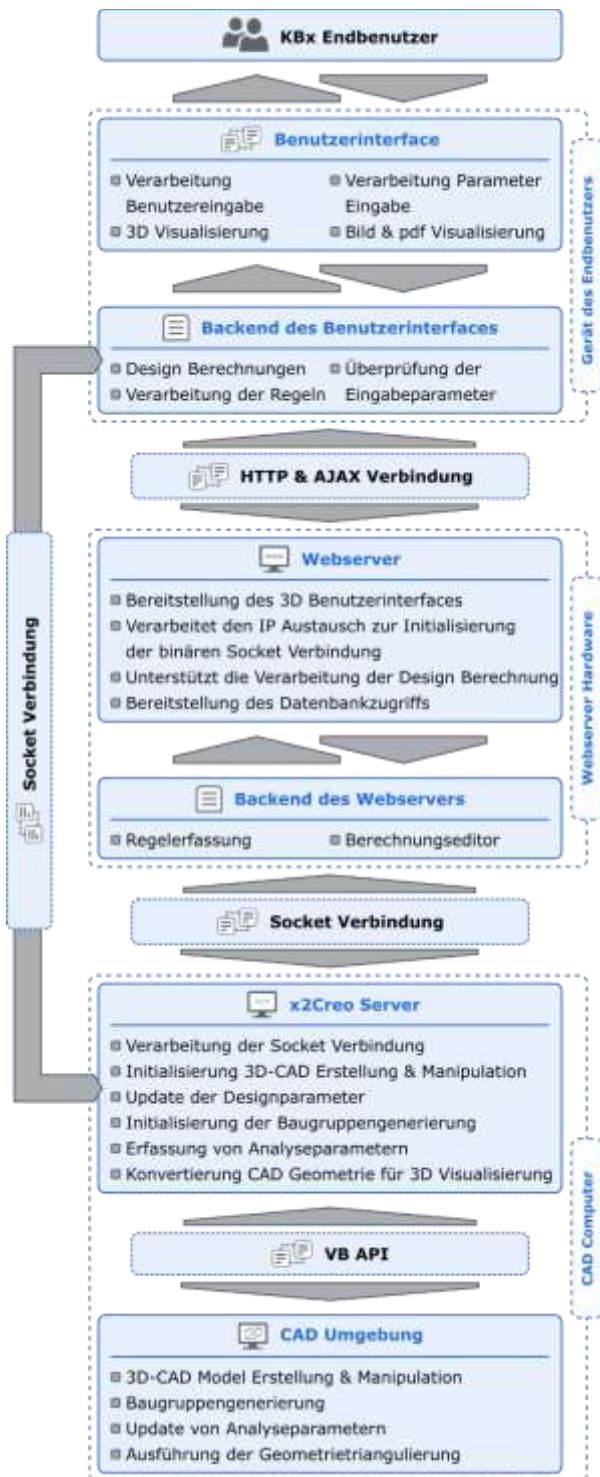
Abbildung 5. Web-basierte Architektur der Implementierung
