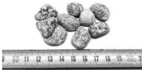
Abbildung 2. Zu kalibrierendes Schüttgut RK 8/16
