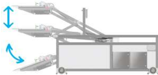
Abbildung 17. Freiheitsgrade des Greifers: Vertikalbewegung und Neigen des Greifers in Anlehnung an [PWH20]
