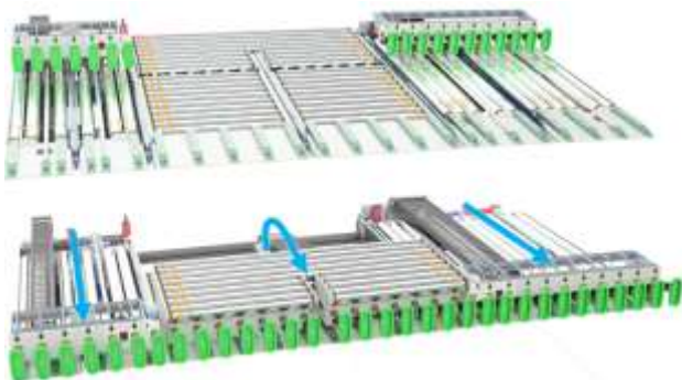
Abbildung 18. Vorwärtsbewegung der drei unabhängig verfahrbaren Greifensegmente in Anlehnung an [PWH20]
