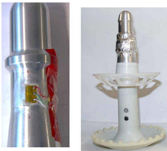
Abbildung 3: Mit Dehnmessstreifen ausgestattetes Messschubelement
