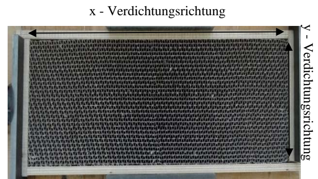
Abbildung 5. Versuchsaufbau zur Verdichtung des sinuswabenförmigen Pappwerkstoffes
