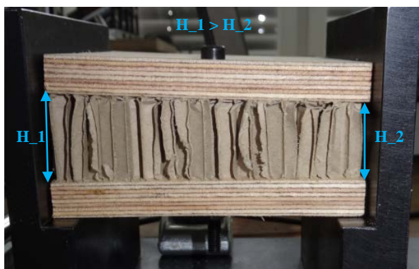
Abbildung 14. Verformtes Sandwichelement mit homogenem Kern durch das Anziehen der Schraubverbindung
