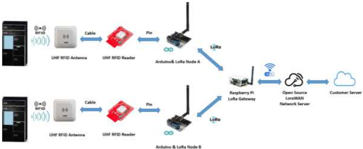
Abbildung 7. Prototyp des EBS-Systems mit LoRa Knoten-Knoten-Modus
