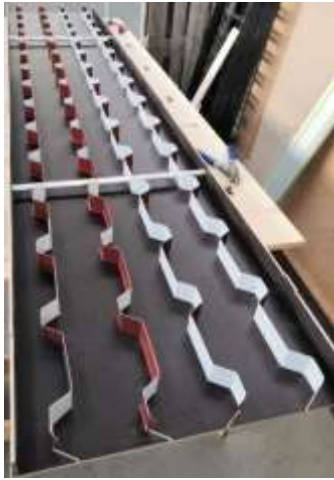
Abbildung 9. Verklebte Struktur mit noch offener Decklage
