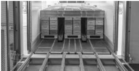
Abbildung 1. Beladesystem auf Basis eines Kettenförderers mit aufwändigen Umbauten in der Halle und im LKW [Fab19]
