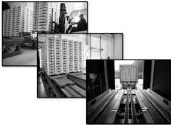
Abbildung 4. Skatesystem in der Halle und im LKW [Anc19]
