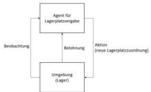
Abbildung 3: Ablauf des Reinforcement Learning für eine automatisierte, datengetriebene Lagerplatzvergabe. In Anlehnung an [DDZ 20].
