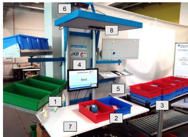
Abbildung 2: Dargestellt ist Aufbau des Konsolidierassistenten [Hoc17] zu Beginn eines Konsolidierprozesses. Die markierten Komponenten sind Konsolidierboxen (1), aktueller Auftrag in Kommissionierboxen (2), Puffer mit weiteren Kommissionieraufträgen (3), Bildschirm für Auftragsverwaltung (4), Ablage für Kommissionieraufträge (5), Projektionseinheit (6), interaktive Tischoberfläche (7), Tiefenbildkamera (8).
