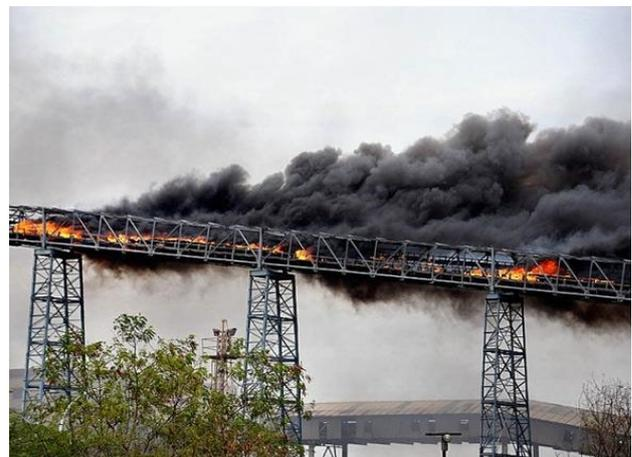
*Abbildung 1: Verheerende Folgen für Bandanlagen durch Brandeinwirkung [Amb16]*
