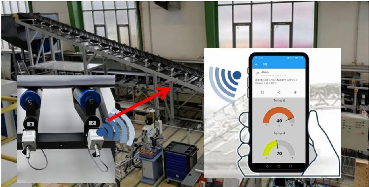
Abbildung 10: experimenteller Nachweis der Funktionsfähigkeit des Gesamtsystems am Gurtförderer-Versuchsstand im industriellen Maßstab am Institut für Logistik und Materialflusstechnik
