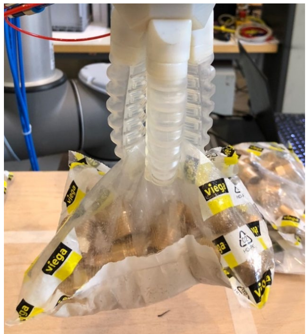
Abbildung 11: Zentrischer 3-Finger-Greifer bei der Handhabung einer Verpackungstüte
