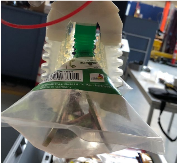
Abbildung 12: Parallelgreifer mit 8 Fingern und Vakuumsaugern bei der Handhabung einer Verpackungstüte
