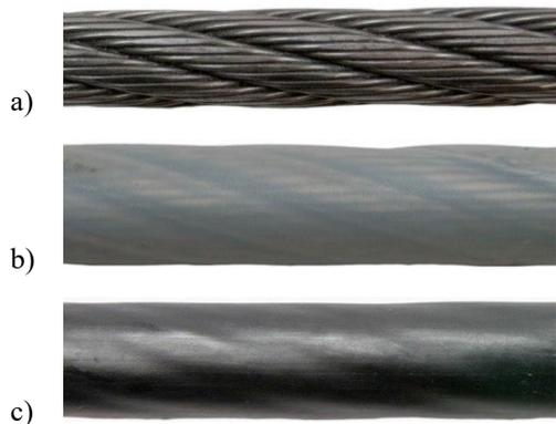
Abbildung 1. Prüfseile a) konventionelles Drahtseil
