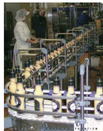
Abbildung 1: Flaschenförderer mit Kunststoffkette
