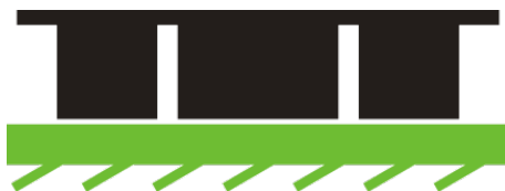
Abbildung 7. Abstützung mit Gleitblechen/-platten
