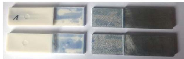
Abbildung 2. Zugscherproben nach der Zugscherprüfung, rechts Zinkdruckguss mit aufgebrachtem Haftvermittler (blau), links PBT mit anhaftendem Haftvermittler
