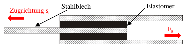
Abbildung 4: Prüfkörper nach DIN 53513
