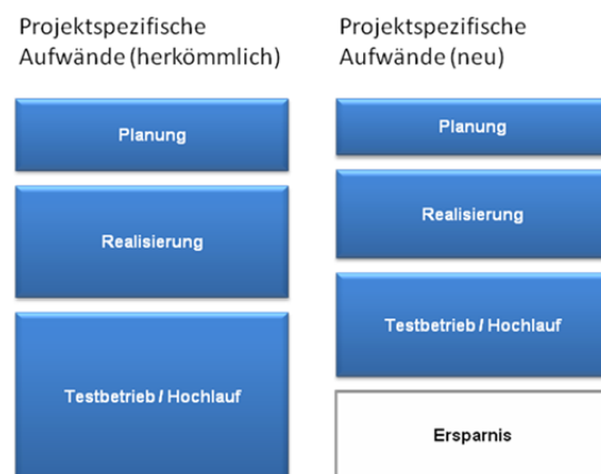
Abbildung 1. Vergleich der projektspezifischen Aufwände für Planung, Realisierung und Test bei Materialflusssystemen mit zentraler Steuerung (l.) und dezentral gesteuerten Anlagen (r.) ([KUZ10], S.9)
