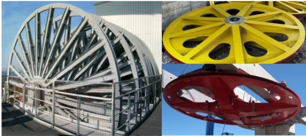
Abbildung 1. (links) mit Speichen (rechts) Vollwandscheibe [Kat12]
