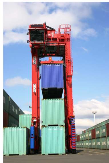
Abbildung 1: Portalstapler beim Ein- bzw. Auslagern in die dritte Containerlage
