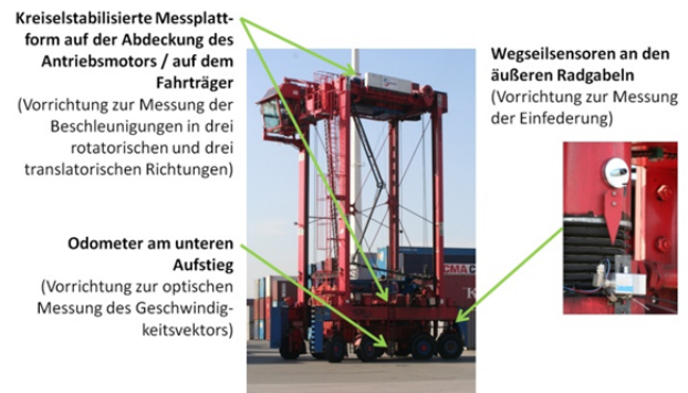
Abbildung 6: Messaufbau zur Validierung des Simulationsmodells
