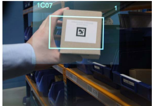
Abbildung 4. Überprüfung optischer Codes mittels einer Kamera im Head-mounted Display
