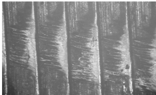
Abbildung 9: beginnende polymere Ablagerung auf Stahlprobe Rz28
