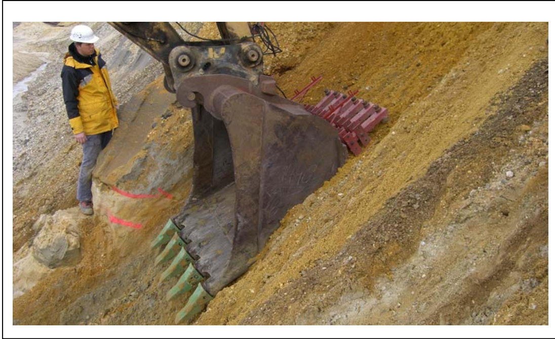
Abbildung 11: Messelektroden auf dem Schaufelrücken im Eingriff am Abbaustößfazit und Ausblick
