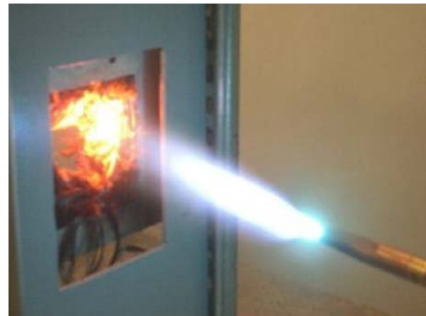
Abbildung 2c: Beflammung des Materials
