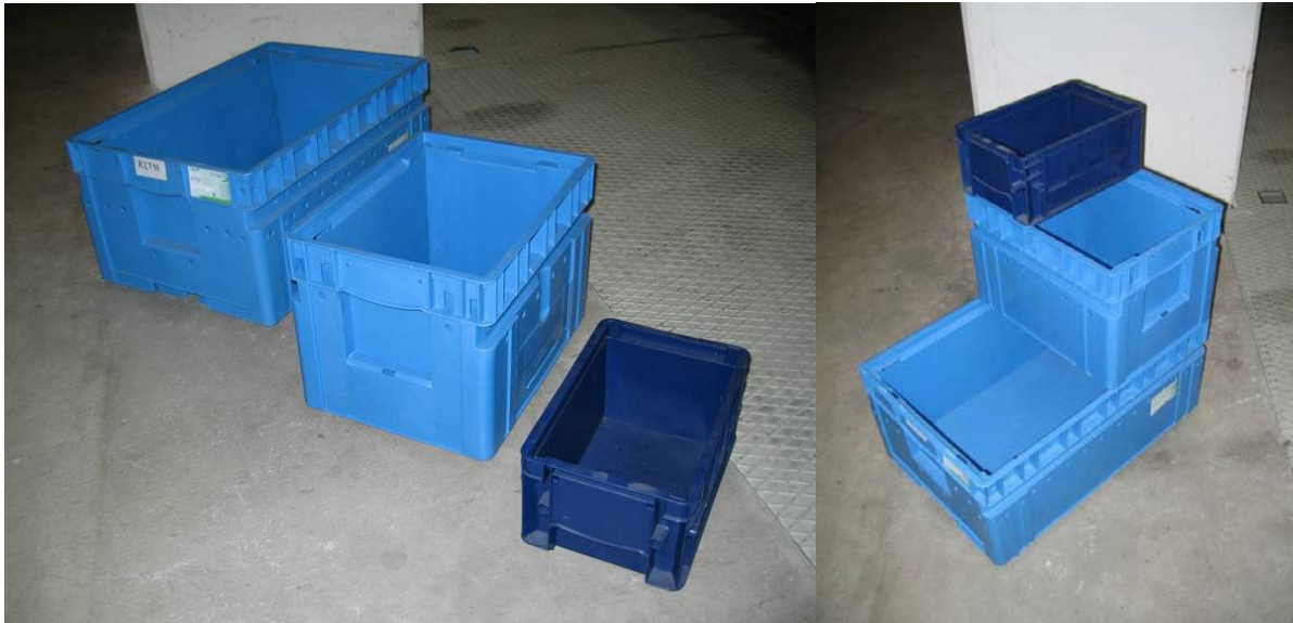
Abbildung 2: Kleinladungsträger (KLT) in 3 standardisierten Größen
