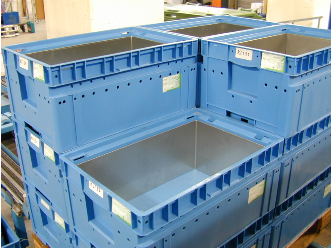
Abbildung 10: KLT mit Aluminiumprofilen
