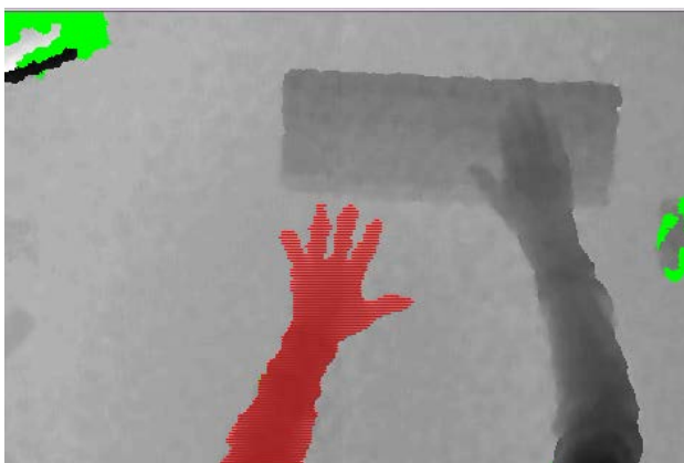
Abbildung 8. Handerkennung und Tracking mittels Tiefenbildkamera
