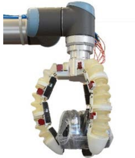
Abbildung 13. Im prismatischen Präzisionsgriff vom Greifer erfasste Kulturtasche am Realmodell
