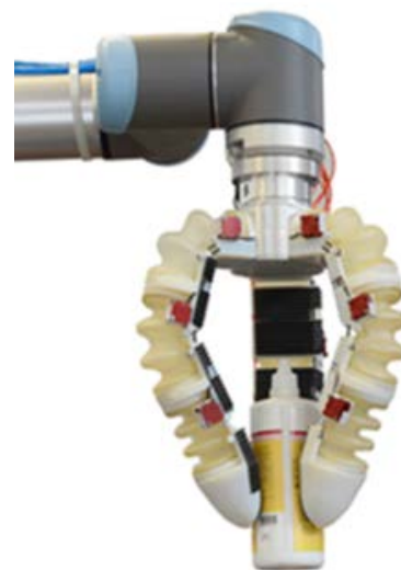
Abbildung 14. Im zirkulären Präzisionsgriff erfasste Flasche am Realmodell
