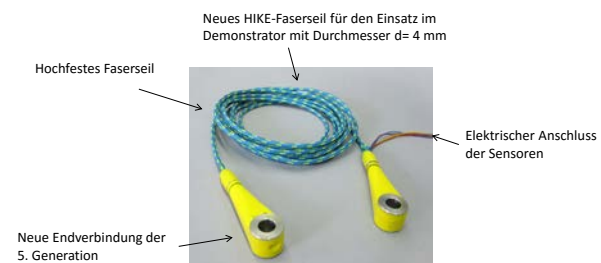
Abbildung 3. Sensorisches Hochfestes Faserseilzugglied
