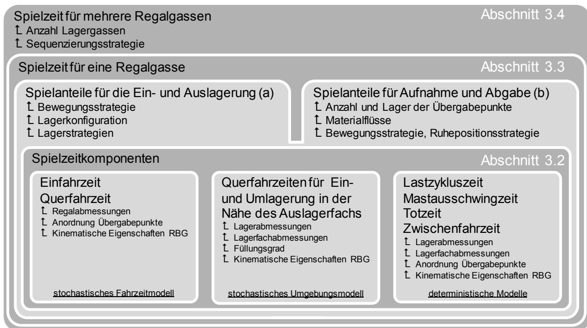
Abbildung 1: Berechnung der Umschlagsleistung eines automatischen Lagersystems; mathematisches Gesamtmodell mit Untermodellen und Einflussgrößen
